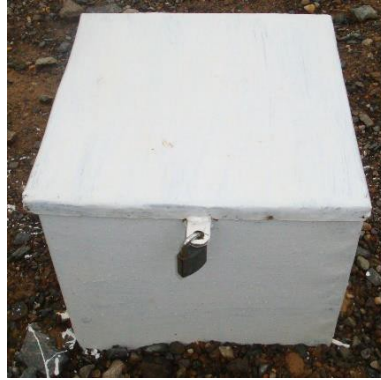
内部位移孔口保护装置实景图
